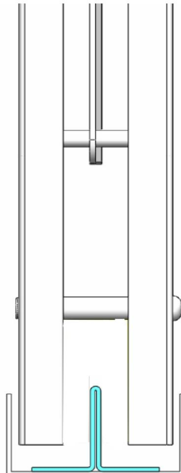
Il sistema di sicurezza si realizza con l'applicazione di uno speciale profilo sagomato a T elettropuntato nella guida inferiore.
